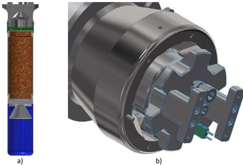
Figura 2 – Solução construtiva adotada para o vaso de extração: a) cápsula porta amostra; b) abertura das tampas tipo baioneta.
