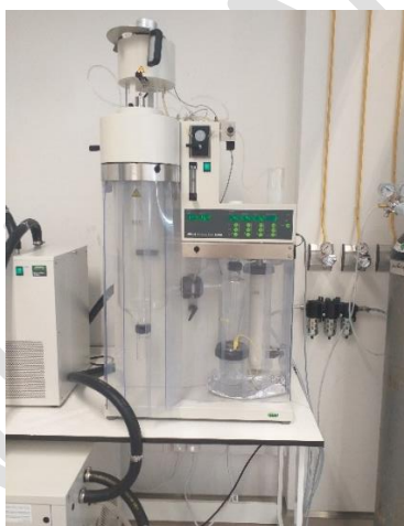
Figura 1. Equipamento de Spray-dryer utilizado para a preparação das partículas.
