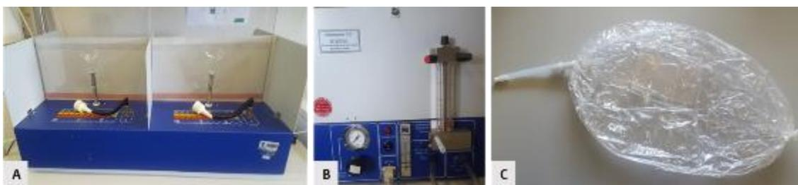
Figura 1: registo fotográfico do olfatómetro modelo Ecoma TO7 (A e B) e saco de amostragem – Nanoplan 5 L (C).
