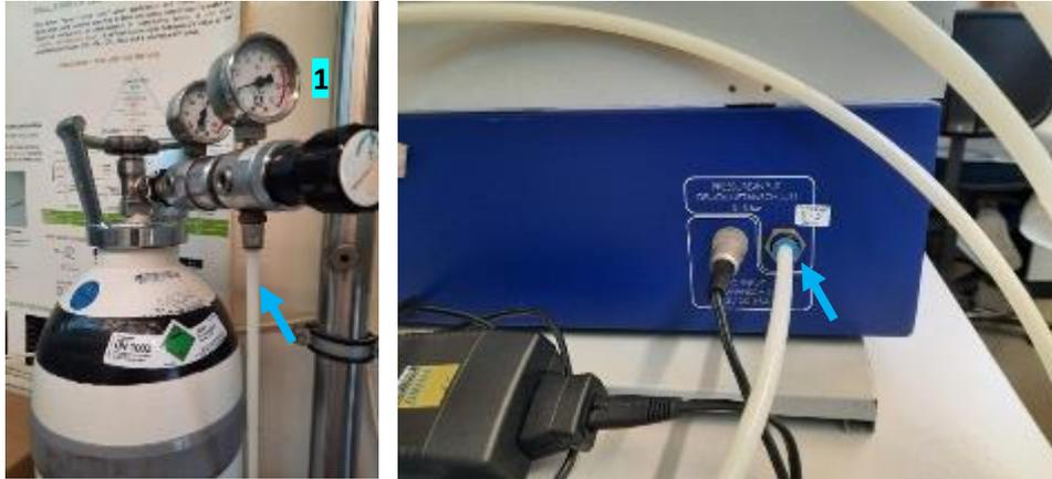
Figura B9: Garrafa de ar comprimido. O regulador (1) regula a pressão, que entra no olfatómetro através do tubo branco visível nas imagens (setas).
