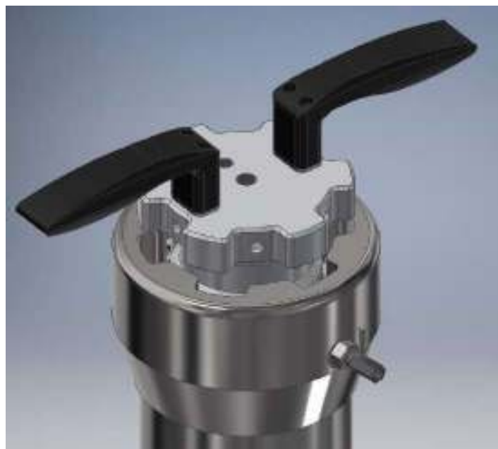
Figura 3 – Conceito final, com fecho em baioneta.
