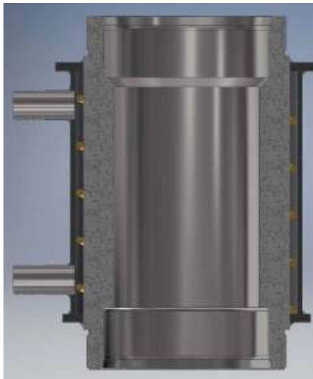
Figura 6 – Circuito de aquecimento dos reservatórios.
