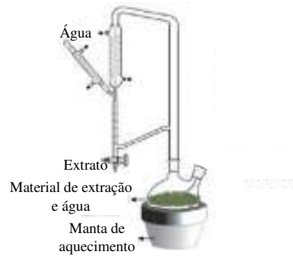
Figura 1 - Esquema do aparelho de Cleverger, próprio para hidrodestilação simples. Fonte: Adaptado de Ferreira et al., 2017.
